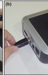
7a. Если вы хотите использовать кабель eSATA, подключите такой кабель к внешнему накопителю
