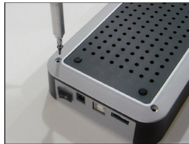
6. Используя два длинных и два коротких винта с нижней стороны накопителя, приверните крышку
