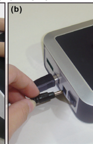
8a. После подключения кабеля eSATA к внешнему накопителю, подключите кабель питания
